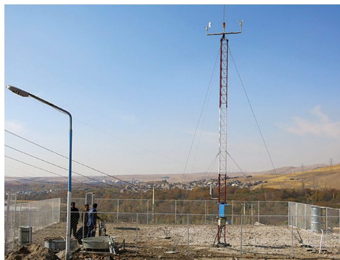
نمونه ایستگاه تبخیرسنجی مجهز به ادوات ثبت و انتقال خودکار داده
