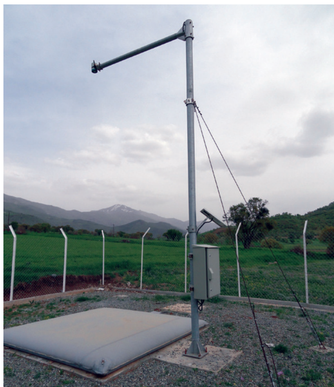
نمونه ایستگاه برف سنجی مجهز به تشک اندازه گیری خودکار ارتفاع و آب معادل برف
